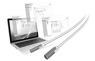
同製品は、1台で2つの出力を保有し、検出領域内でフィーディング方式によって最適な動作点を設定する自動チューニング機能を搭載している。2つの出力は動作モードを組み合わせて、これまで2台の近接スイッチが必要だったアプリケーションを1台で対応できる。さらに、パソコンの専用設定ツールで、センサのチューニング状態の余裕度を可視化でき、短時間で安定した検出状態に調整することができる。
