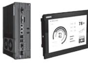
産業用PC「NY5□□-1」は、装置制御用途に特化したIPCマシンコントロールとして、Sysmacの高い精度や実用性と、Windowsの汎用性を兼ね備えている。2つのプラットフォームは独立して同時に動作し、Windows側に異常が発生した場合でも制御側は動作を継続。生産ラインを止めない。PLC並みの高い信頼性やロバスト性で、ビッグデータやNUI、IoTなどの活用を容易にする。新たにVESA規格(100x100)に対応した取り付け金具を用意し、さまざまなアームやスタンドに取り付けることが可能となっている。
